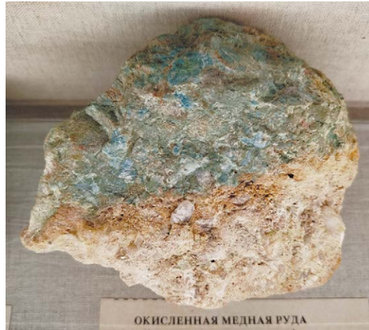
Рис. 7. Окисленная медная руда. Иран, Анарекский район. ВФ 7458. Fig. 7. Oxidized copper ore. Iran, Anarek region.
