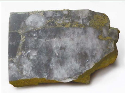
Рис. 5. Кварцевый конгломерат из золотоносной провинции Витватерсранд, ЮАР. ОФ 784. Фото А.А. Косныревой.
